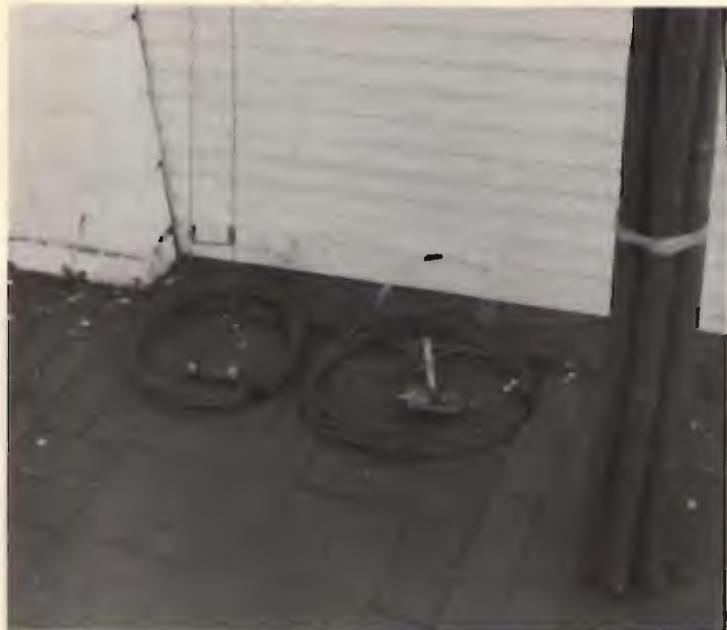
In primo piano il "fascio" di canne di bambù già pitturate a smalto. Segue il cavo dell'elemento pilota e relativo SO239 sulla sua bassetta in PVC. Cavo dell'elemento riflettore e relativa sezione di accordo (in rame rigido).
