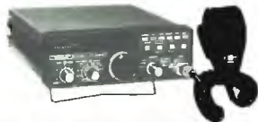
FT 480 R: ricetrasmittitore per i due metri in SSB-CW-FM da 143,500 a 148,500 Mhz - 30 W PEP - doppio VFO - 4 memore - speciale per satelliti.
