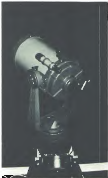
Telescopio a specchio Schmidt-Cassegrain. Ø 20 cm, focale 200 mm. Nella base, sotto la « forcella », il motore sincrono per il moto orario.
