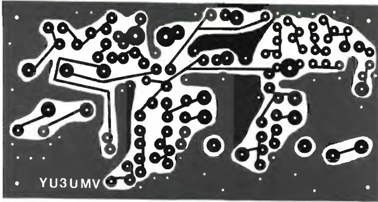
Circuito stampato del trasmettitore: prima piastrina. Lato rame.
