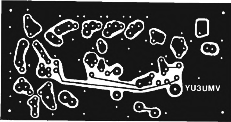
Circuito stampato della prima conversione del RX. Lato rame.
