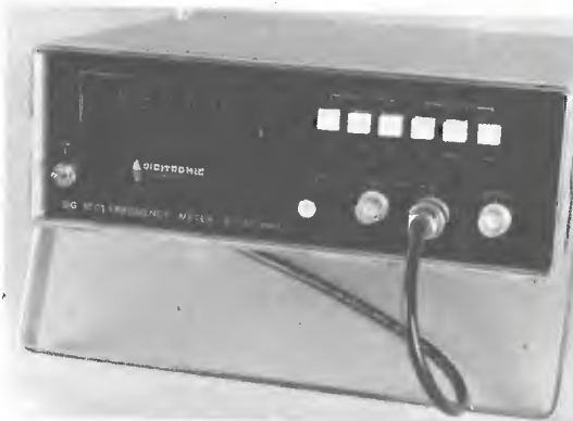
DG1002 FREQUENZIMETRO DIGITALE 300 MHz
