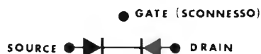
Circuito equivalente di un MOSFET enhancement a canale P con il gate sconnesso.
