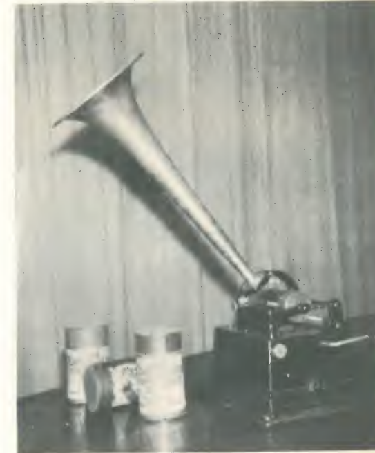
Lo stesso visto dal lato manovella; il piccolo bottone che luccica al bordo superiore è il regolatore di velocità.
