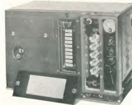
Trasmettitore BC604 con lo scomparto delle unità a quarzo aperto
