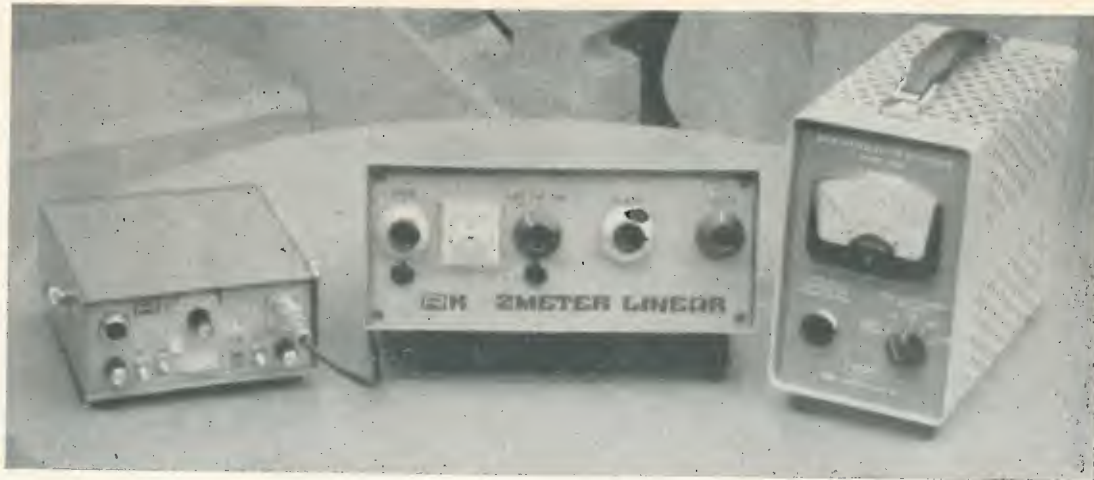
Il lineare pilotato da un piccolo transceiver e controllo di potenza con wattmetro RF.
