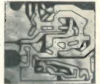
... al circuito stampato (positivo) finito e pronto per la foratura in scala 1:1.
