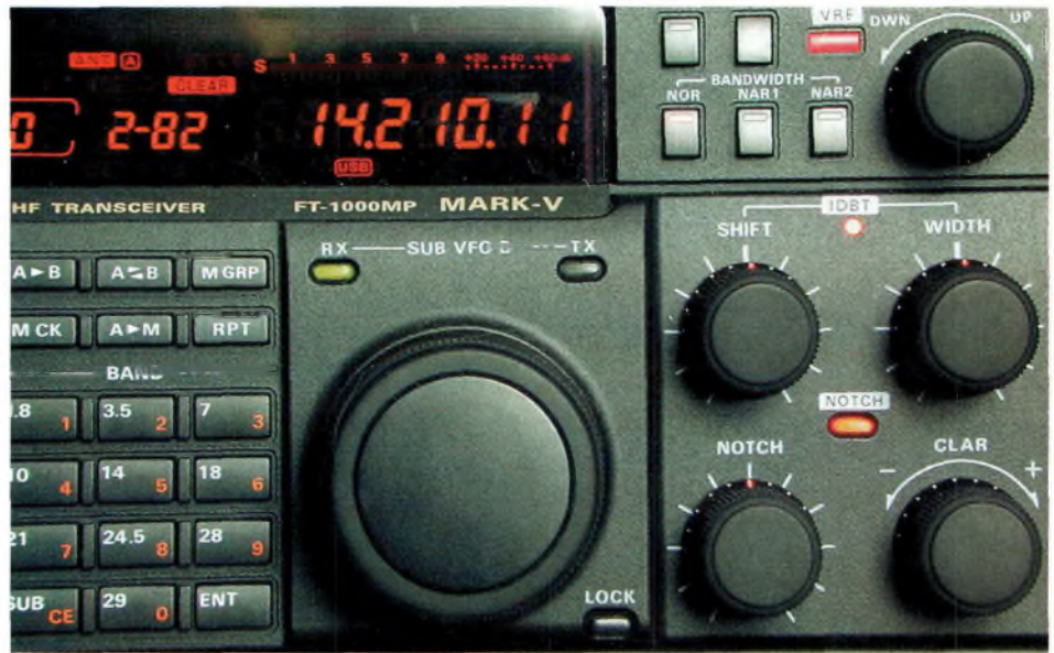
Bien qu'indépendant, le second récepteur subit les réglages du récepteur maître.
