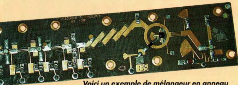
Voici un exemple de mélangeur en anneau sauf qu'ici c'est un hybride de type «course au rat» qui est utilisé.
