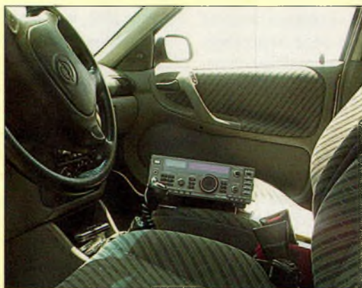
Rien de compliqué à l'intérieur. Le poste prend place sur le siège passager permettant une connexion et une déconnexion rapide. Cette installation me convient car j'opère seulement quand la voiture est à l'arrêt.
