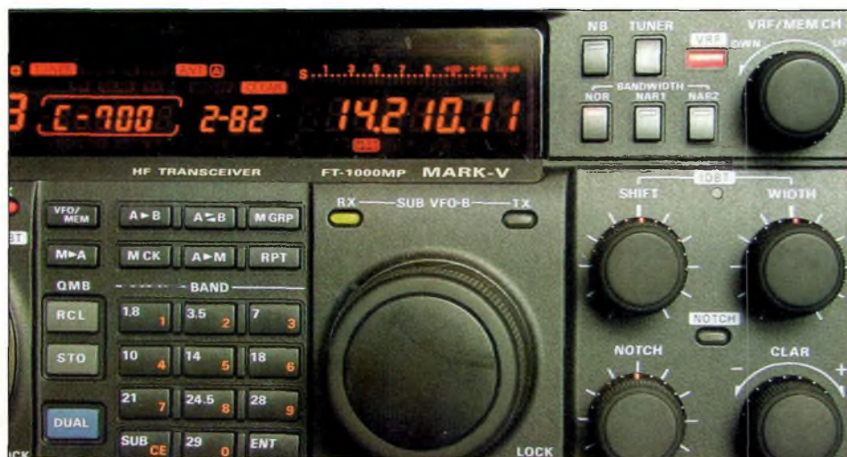
Le bouton VRF/MEMCH optimise la sélectivité des étages d'entrée.
