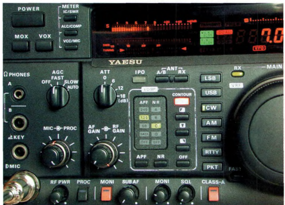
En dessous du 5mètre l'un des deux indicateurs sert à vérifier le courant, l'ALC, le ROS, le niveau micro, etc. L'autre offre la particularité de surveiller l'accord de la boîte automatique.
