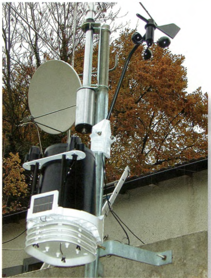
Voici la base externe installée en extérieur. Bien entendu, ici ce sont les besoins de l'essai qui nous ont conduit à l'installer au plus simple. Dans la pratique, les capteurs éoliens doivent se retrouver le plus haut et le plus dégagé possible.
