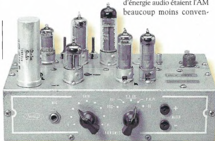
Photo 2- Le Tecraft CC-50 était souvent utilisé conjointement avec l'émetteur Tecraft TR-20/50 représenté ici.
