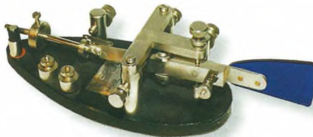
Photo 10- Voici quelque chose que vous ne verrez pas tous les jours : un manipulateur italien unique pour les gauchers Vibrax Model 3. Imaginez votre main sur la touche de commande et remarquez que les contacts des points et des traits sont situés sur le côté opposé au côté habituel. (Photo de Gil, K9WDY)
