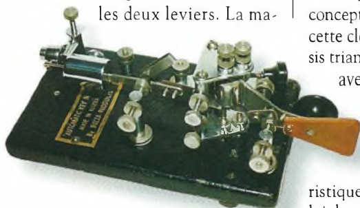
Photo 9- L'Australie était aussi connue pour ses manipulateur de classe mondiale autrefois et son manipulateur Buzza Products est un bon exemple. La clé comporte deux épingles à pivot et un mécanisme de bascule recherché et fonctionne très bien. (Photo faite avec la permission du fier propriétaire K9WDY)
