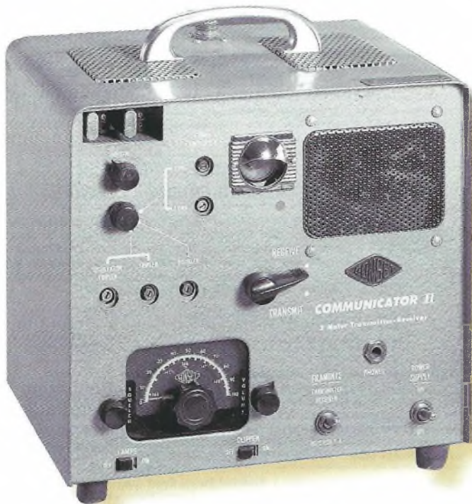
Photo 5- Le Communicator II de Gonset, une combinaison émetteur/récepteur VHF et le successeur du Communicator ajoutait un réglage audio silencieux et une prise pour les écouteurs.
