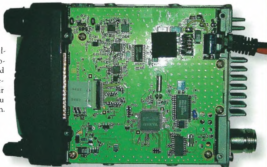
L'électronique du FT-90R se répartit sur deux platines.
