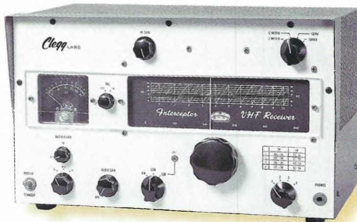
Photo 4- Un récepteur de compagnie pour le Clegg Zeus : outre l'AM et la CW, l'Interceptor recevait aussi la SSB.
