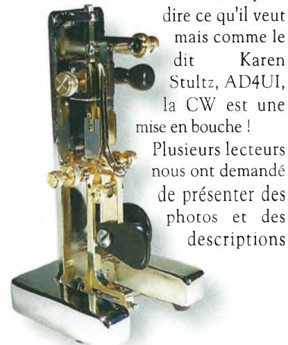
Photo 1- L'une des clés les plus intrigantes de tous les temps est le manipulateur droit ou vertical. Cette petite pièce précieuse utilise un seul ensemble de contacts pour produire des points et des traits. Le mécanisme pivote vers l'arrière pour produire des points et les pivots au centre pour faire des traits.
