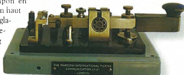
Photo 12- Cette clé exceptionnellement grande est le Model 365 fabriquée par Marconi Wireless Company en Angleterre. Elle était très populaire à bord des navires britanniques il n'y a pas longtemps. (Photo faite avec la permission du fier propriétaire Flavio pendio de Freitas, PY4BG)
