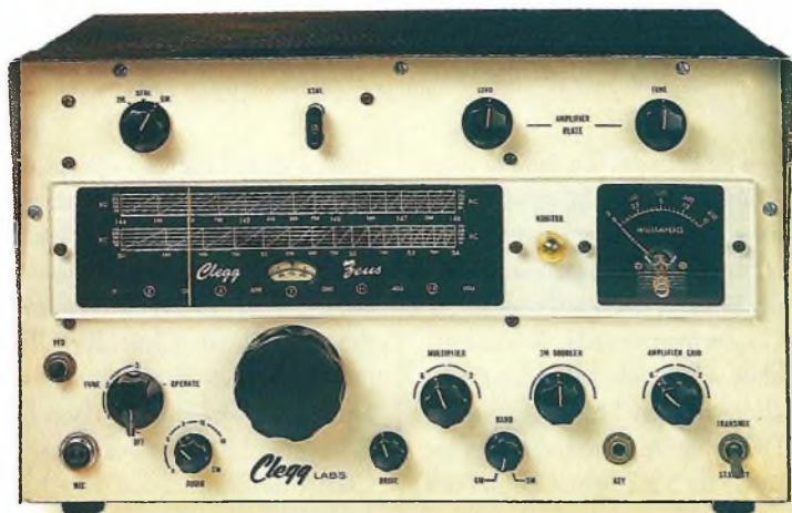
Photo 3- Le Clegg Zeus, un contrôleur VFO, 175 watts, émetteur AM et CW pour les 6 et 2 mètres, il coûtait 559 $ quand il a été introduit en 1961.
