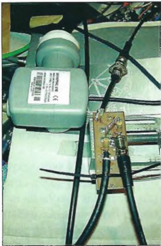
Le prototype du convertisseur pour la réception du 10 giga.
