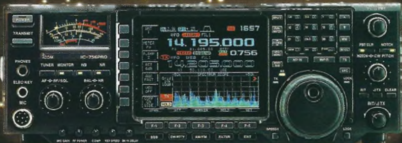
IC-756PRO TOUS MODES DSP NUMERIQUE A VIRGULE FLOTTANTE HF - 50 MHZ / 100W - ECRAN TFT 5 POUCES COULEUR
