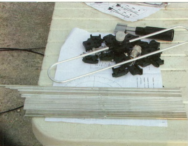
Hormis les éléments en tube carré qui forment le châssis de l'antenne, voici toutes les pièces pour la terminer. Notez les 20 éléments rangés par ordre de longueur.
