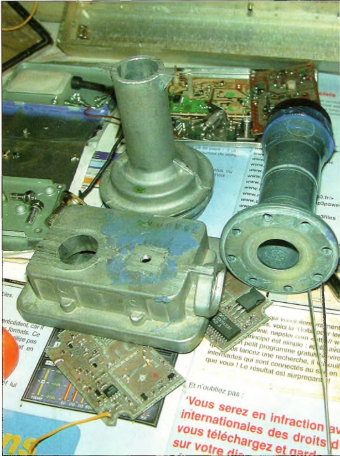
Fig. 2-D'un coup de scie à métaux, on libère le guide d'onde et son cornet. Notez à droite, un cornet et son adaptateur vers guide que l'on rencontre sur certaines tête distribuées par Tonna.
