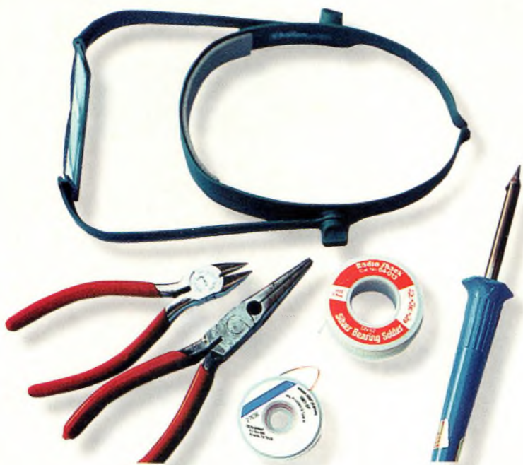
Photo 6- Les outils nécessaires pour monter un kit. Notez la présence d'une loupe grossissante à fixer sur la tête. C'est un outil qui s'avère très pratique lors des opérations de soudure.
