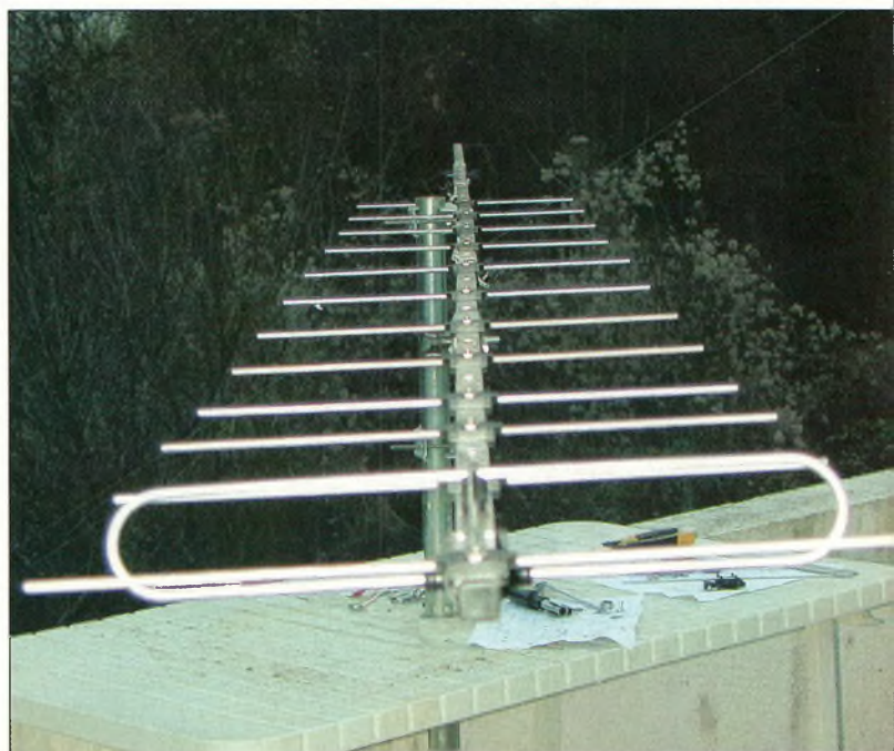
Avant de monter l'antenne sur le pylône, il faut régler les jambes de force pour aligner le boom. Il faut qu'elles soient parallèles au sol. Un morceau de tube à la place du parasol d'une table de camping est d'une aide précieuse.
