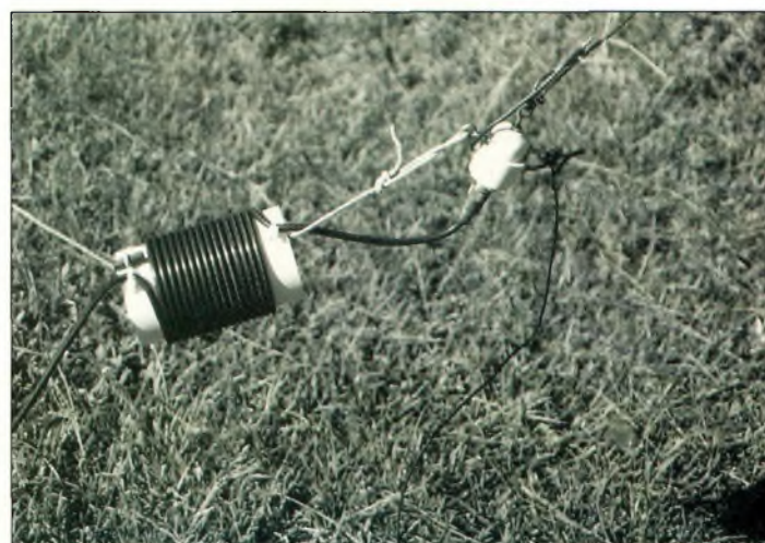
Détails du balun, du hauban et du connecteur coaxial.
