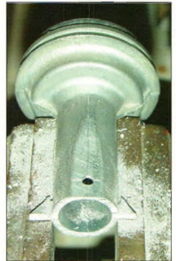
Fig. 5-Le trou de passage sera centré avec le plus de précision possible.
