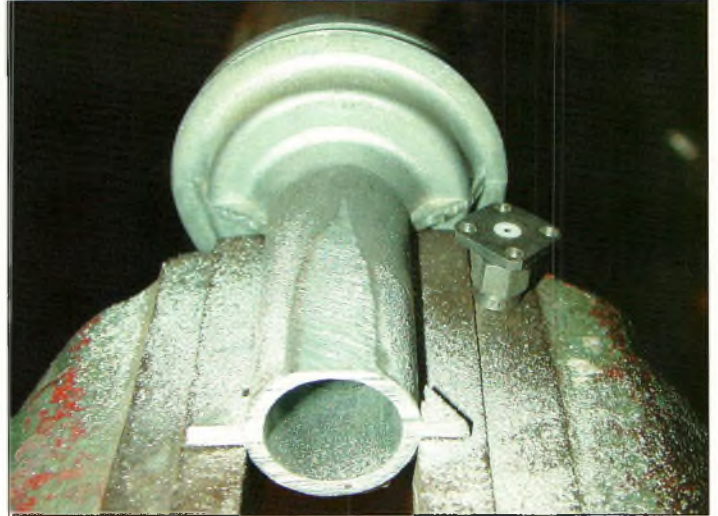
Fig. 3-On doit pratiquer un méplat sur la circonférence du guide pour faire tenir l'embase du connecteur SMA.
