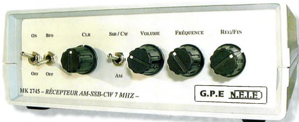
Le récepteur 7 MHz à BFO en France par Nouvelle Électronique Import/Export, le "MK2745".
