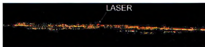
Fig. 1 - A une distance de plus de 85 km, un laser de 5 mW reste l'objet le plus visible. Voici ce à quoi un laser peut ressembler au milieu des éclairages d'une grande ville.
