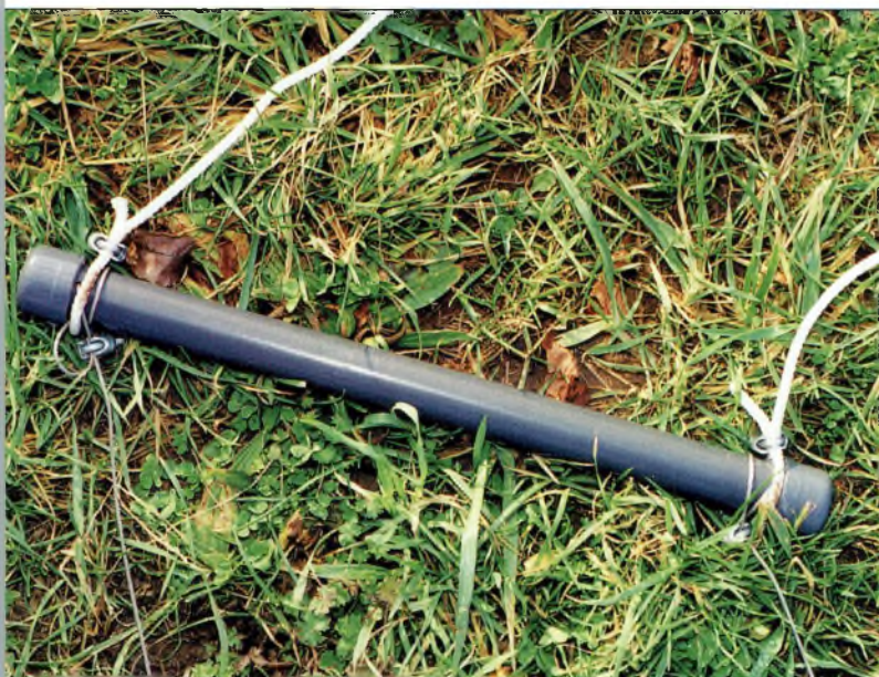
Les écarteurs aux deux extrémités de l'antenne.
