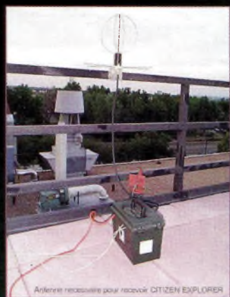
Antenne "egg-beater" pour recevoir CX.
