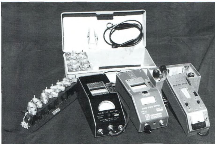
Trio de grid dip. De gauche à droite : le Millen 90651 avec son assortiment de bobines, le Millen/Caywood 90652 avec sa sonde, puis, le Eico 710 avec ses bobines.
