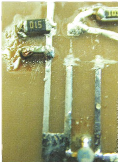
Notez le grattage des lignes couplées pour assurer l'accord en fréquence.
