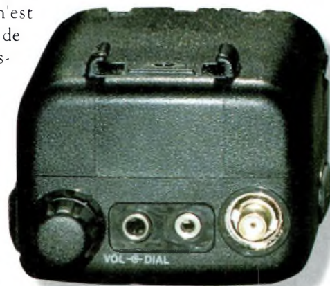
Le dessus de l'appareil avec la fiche SMA recevant l'antenne et les prises jack pour les accessoires externes.
