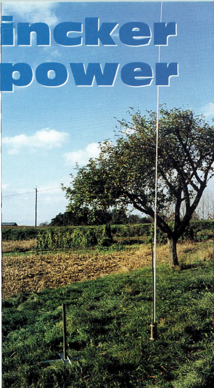
L'antenne Decapower, une verticale toutes bandes fonctionnant entre 1,8 et 32 MHz.
