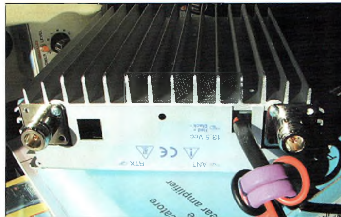
Les connecteurs N d'entrée et de sortie.
