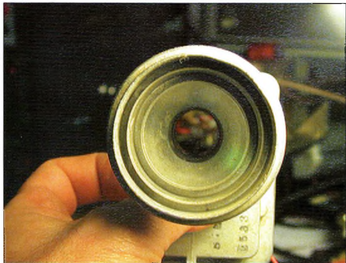
Le cornet d'émission recevra sur le devant une protection qui sera, selon les approvisionnements, soit une feuille de Téflon ou un morceau d'époxy.
