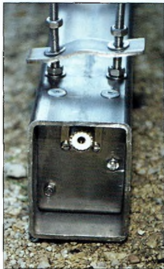
Une fiche SO-239 pour la connexion de l'antenne au coupleur. Une fiche au standard "N" est disponible à la demande.
