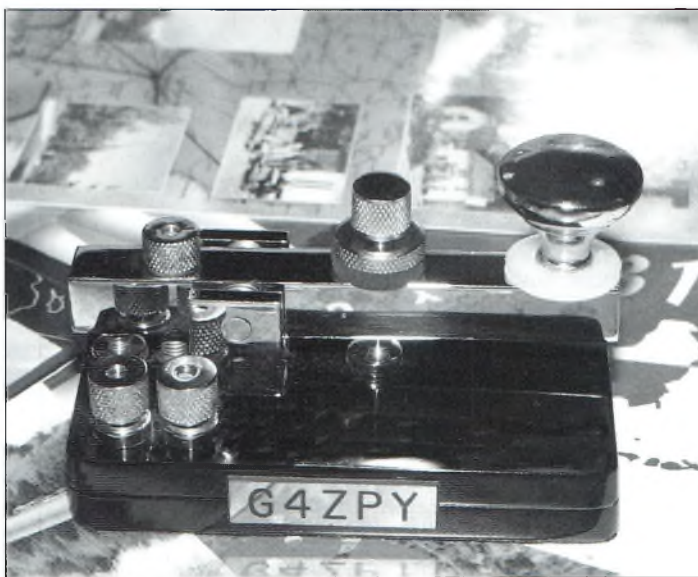
Remarquez la finition très soignée. On pourrait par contre reprocher l'espacement très réduit entre les deux bornes de liaison avec le transceiver.
