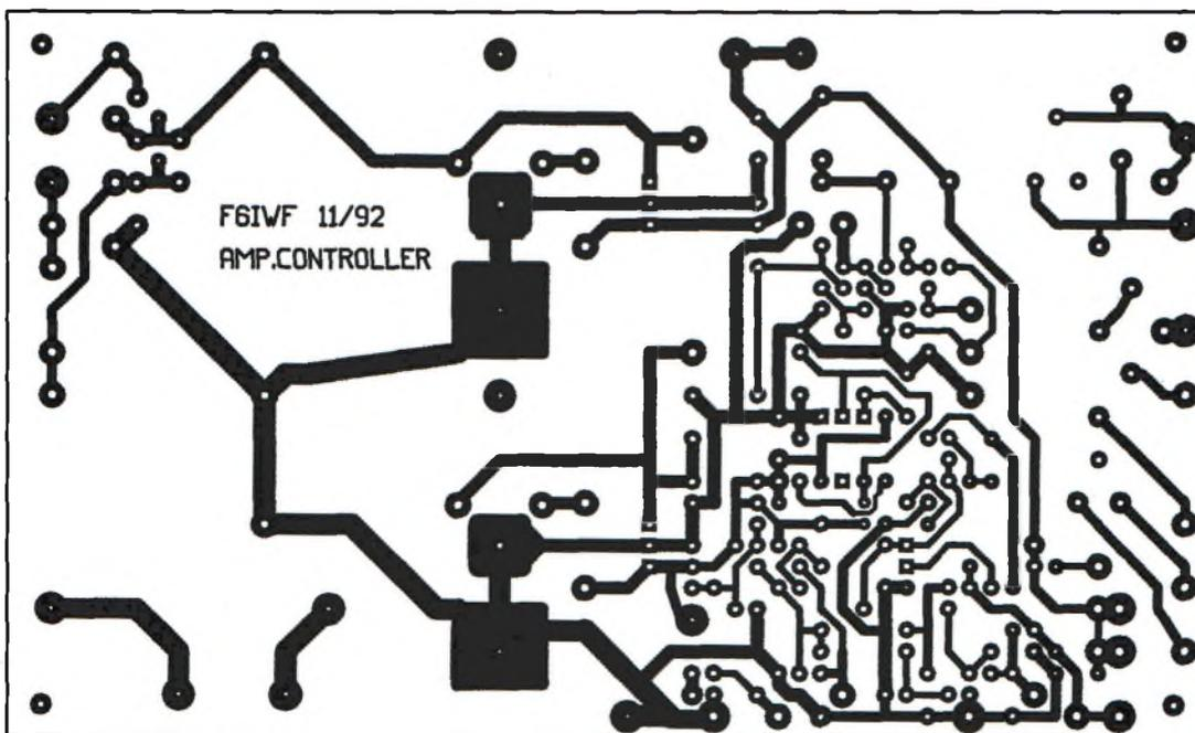
Fig. 7— Circuit imprimé de la platine de commande.
