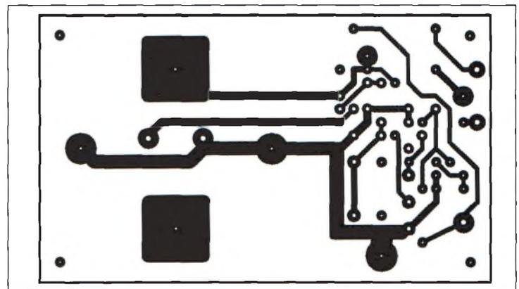
Fig. 9— Circuit imprimé du circuit de polarisation.
