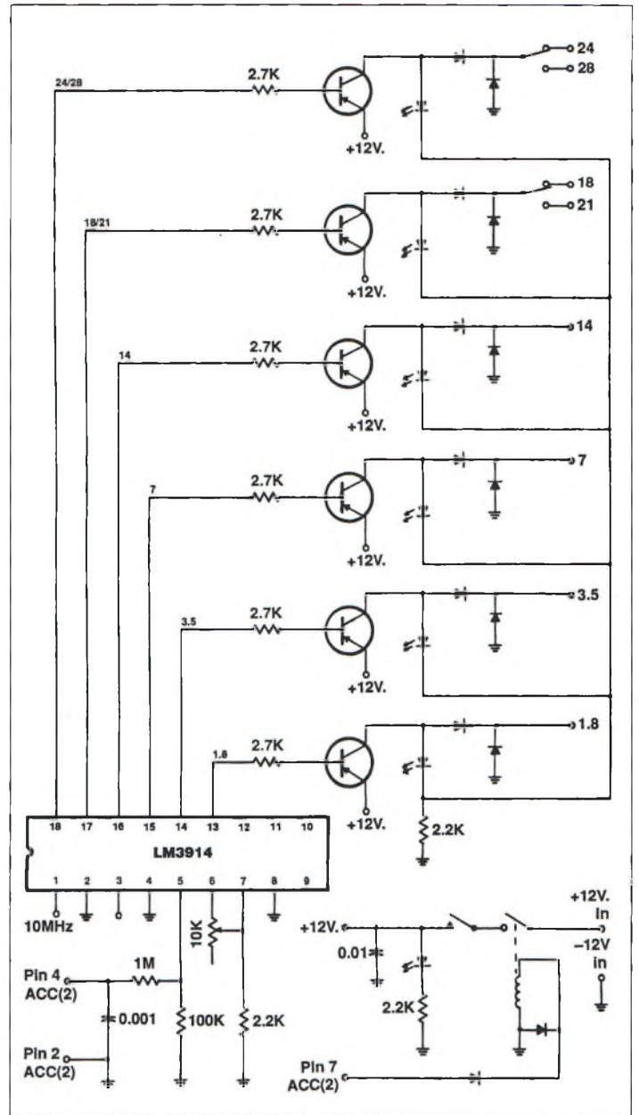
*Fig. 1— Schéma de principe du commutateur automatique d'antennes.*
