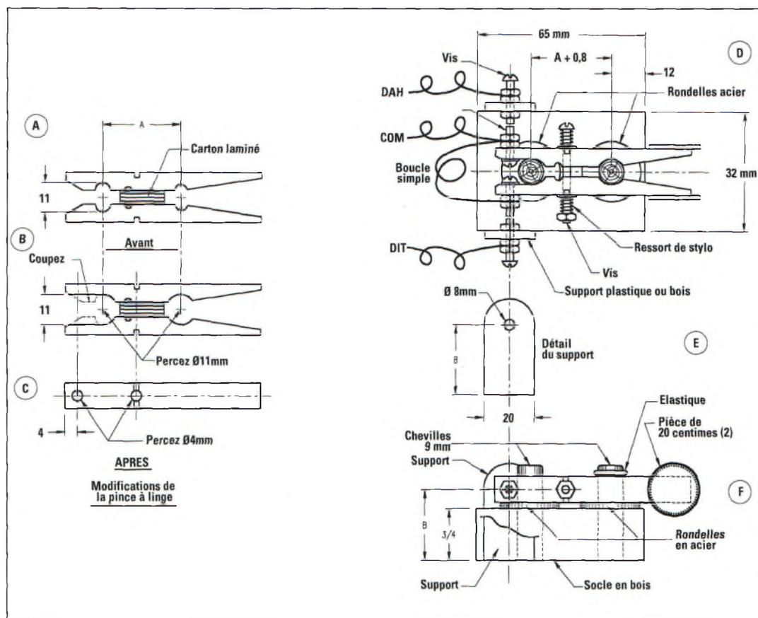
Fig. 1— Schéma mécanique du manipulateur iambique à 40 centimes.
