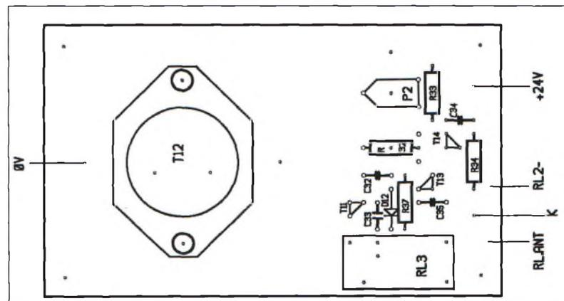
Fig. 10— Schéma d'implantation des composants du circuit de polarisation.
