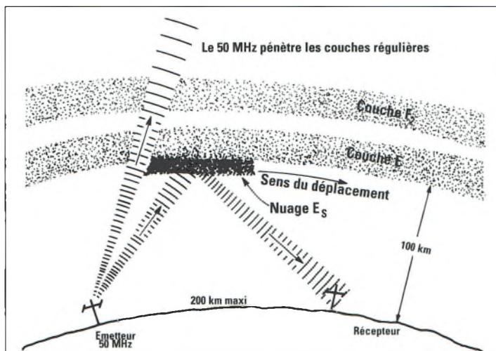
Fig. 1— Propagation d'un signal 50 MHz par réflexion E<sub>s</sub>.
