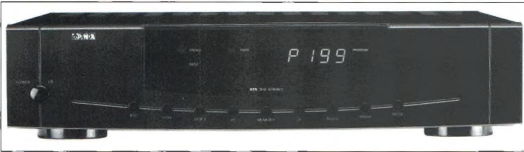
*Sur 1 255 MHz, on peut utiliser un récepteur satellite. Cela permet d'être QRV tout de suite sans attendre la construction d'un récepteur spécial. Cette solution largement utilisée est un bon point de départ.*
