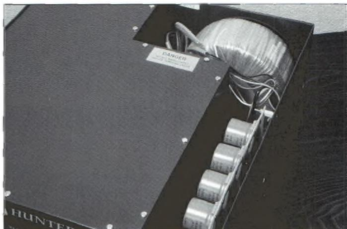
*Le transformateur torique assure l'ensemble des tensions nécessaires au bon fonctionnement du circuit. Il est, bien entendu, surdimensionné. Le capot (sur la gauche) doit être enlevé avant la première utilisation afin d'ôter la mousse destinée à protéger le tube.*
