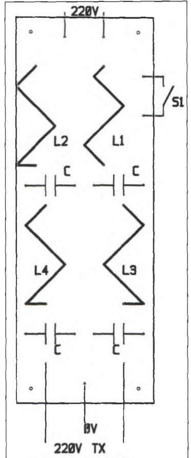
Fig. 14— Schéma d'implantation des composants du filtre secteur.
