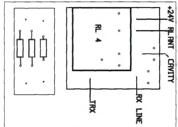
Fig. 16— Schéma d'implantation des composants de la platine de commutation.
