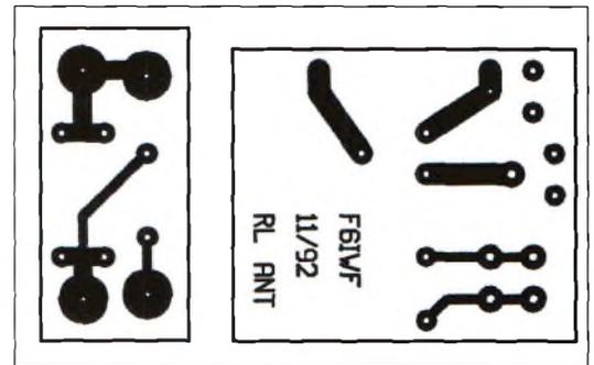
Fig. 15— Circuit imprimé du relais de commutation.
