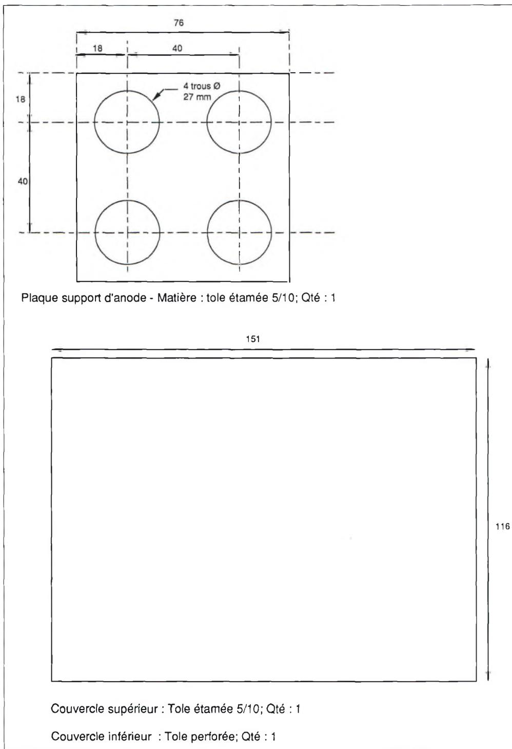
Fig. 22— La plaque support anode et le couvercle.
