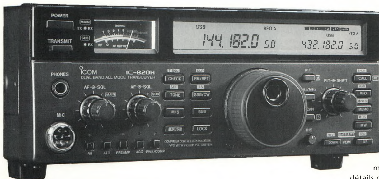
En station de base, un émetteur-récepteur spécialement étudié pour cette utilisation est un choix judicieux. Les commandes y sont accessibles avec beaucoup plus de facilité.
