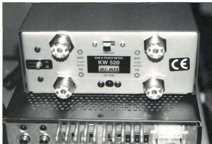
Quatre connecteurs SO-239 sont présents à l'arrière du boîtier.
