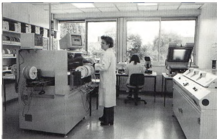
Avant toute manipulation sur les appareils, ceux-ci subissent un temps de chauffe de 8 heures, après quoi ils sont soumis aux réglages.
