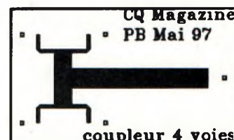
Fig. 4— Tracé du coupleur quatre voies 23 cm.
