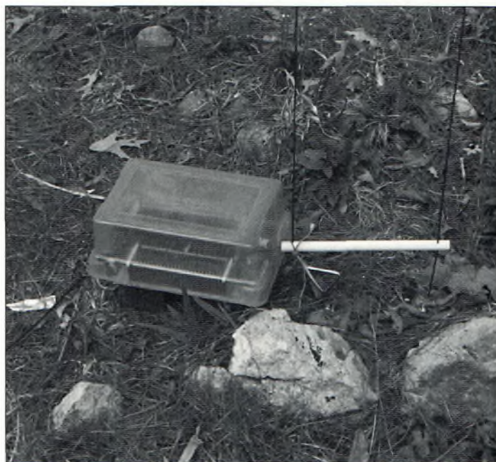
Un coffret constitué d'une boîte Tupperware® fournit un minimum de protection au circuit d'accord. À droite, on peut voir l'un des écarteurs en PVC.
