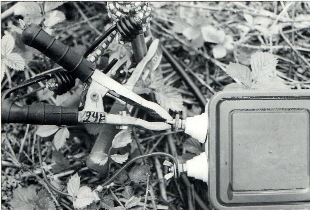
Boîte étanche, en plastique, pour le raccord à la prise de terre et à la sortie du câble coaxial.
