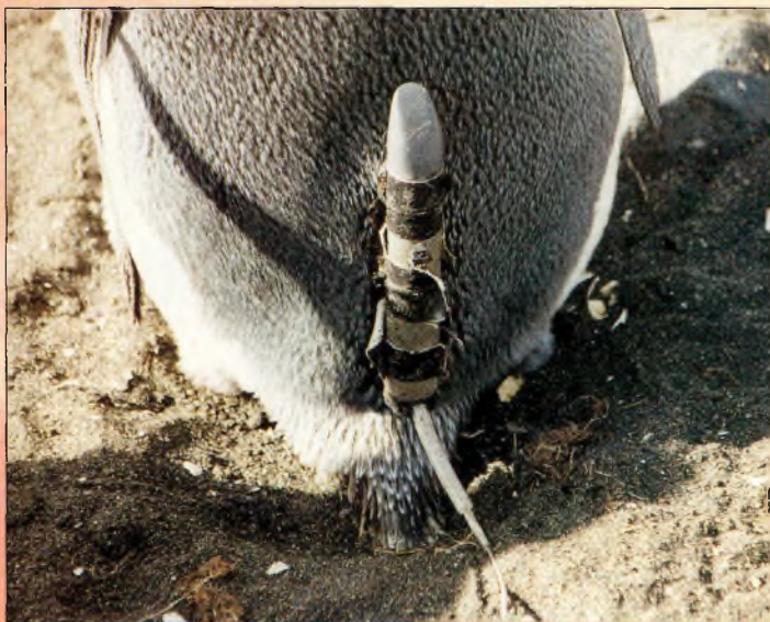
Le CNRS effectue des expériences avec l'aimable collaboration des manchots. Ici, une balise 400 MHz permettant la poursuite des manchots dans leurs déplacements.
