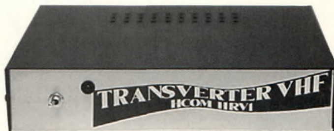
Le transverter 28/144 MHz à l'état de prototype.
