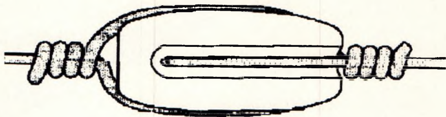
Isolateur, fixation en torsadant le fil.
