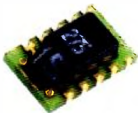
Senzor SHT15 od GME ( 7,4 \times 4,9 \text{ mm} )
