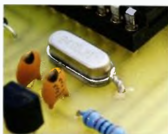
Obr 4. Detail uzemnenia puzdra kryštálu
