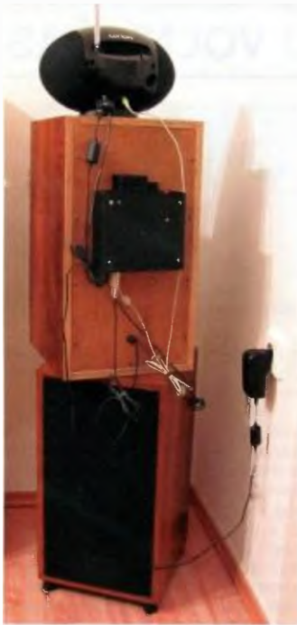
Obr. 9 Celá sestava při pohledu zezadu, na zadní straně horní reproduktorky je vidět namontovaný zesilovač s kabely a přepínací skříňkou, nahoře je přijímač
