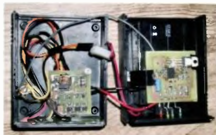
Obr. 9. Fotografie vnitřního uspořádání svítilny
