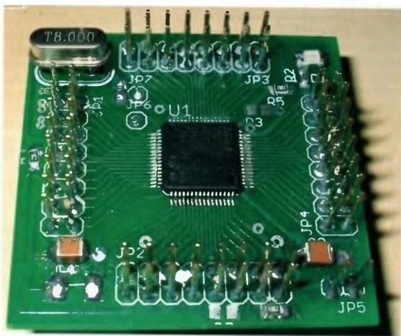
Obr. 3 Palubní počítač s obvodem STM32F100
