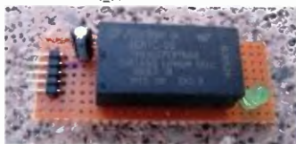
Obr. 5. RTC obvod M41T00CAP
