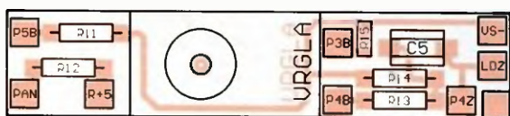
Obr. 53. Deska s plošnými spoji VRGLA (měřítko 1 : 1)
