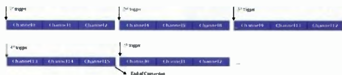
Obr. 34 Postupné pripájanie skupin kanálov k A/D prevodníku
