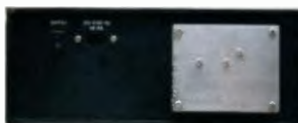
Obr. 62b. Umístění chladiče na zadní straně rozmitače
