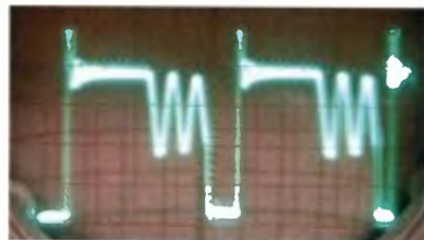
Obr. 4. Oscilogram napětí na svorkách výkonového tranzistoru MOSFET
