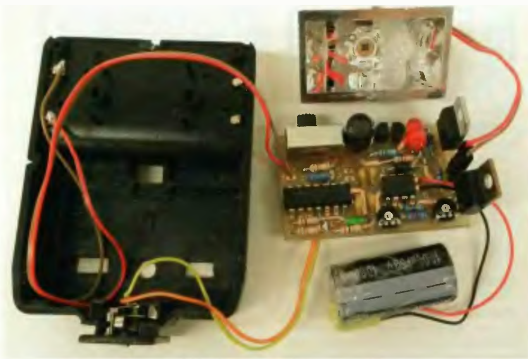
Obr. 5. Pohled na rozložený blesk a různé konfigurace výkonových LED, které pro něj lze využít
