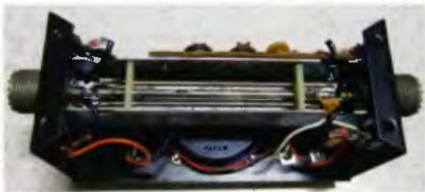
Obr. 17. Vnitřní a vnější provedení měřiče PSV . Přístroj často sdružuje i funkci měření výkonu do zátěže
