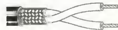
Obr. 17. Twinax. Nejde v pravém slova smyslu o koaxiální kabel, ale o stíněný kroucený pár
