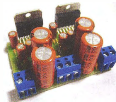
Obr. 32. Příklad řešení modulu zesilovače s obvody TDA7294
