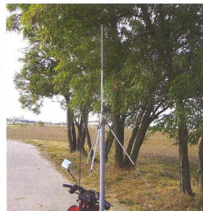
Obr. 11. Zajímavé je, když necháte jednu protiváhu delší a dvě stáhnete, anténa se náhle stane směrovou (zde na FM CCIR)! Kupodivu dokonce „jednosměrně“, čili směr příjmu je přesně opačný, než míří ta delší protiváha! Vyzkoušeno na maďarské stanici na 107,2 MHz, která byla jediná dost slabá, aby se to poznalo. Ty dvě krátké protiváhy tam musí zůstat, jinak to už zase nefunguje
