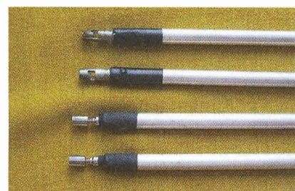
Obr. 4. Upravené konce teleskopických prvků (bez stahovací s-pásky). Zde jsou spodní konce zanytovány, horní konce zalisovány a přetaženy samosmršťovací bužirkou (viz též obr. 5 a 6)
