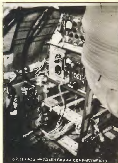
Obr. 1. Přijímač APR-4 s přepínatelným rozsahy 40 – 4000 MHz byl používán americkým letectvem k radioelektronickému průzkumu
