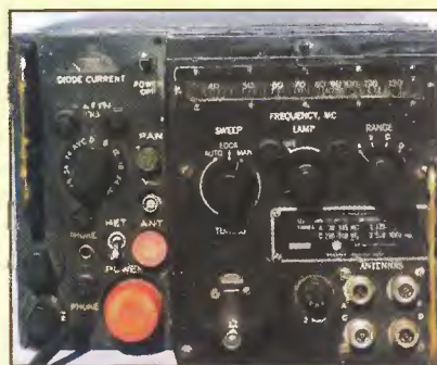
Obr. 1. Přijímač APR-4 s přepínatelným rozsahy 40 – 4000 MHz byl používán americkým letectvem k radioelektronickému průzkumu
