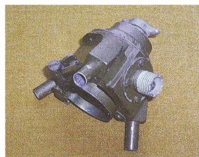
Obr. 2, 3. Originální patka z původní vojenské antény
