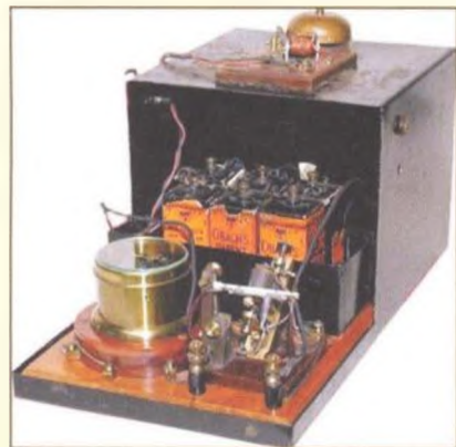
Obr. 2. Marconiho přijímač s kohererem (detektorem) vytažený ze skříňky, která přijímač určitou dobu chránila před očima jiných vynálezců
