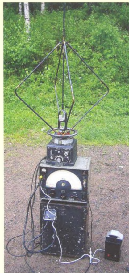
Obr. 5. Zaměřovací souprava typu FuPeil.E.c1 ze sbírky LA6NCA. Nahoře otočná soustava antén, pod ní anténní přepínač, přijímač AE1020, skříňka se zdroji a příslušenstvím
