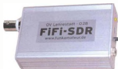
Přijímač FiFi-SDR je v použití o rozměrech 110x50x24 mm
