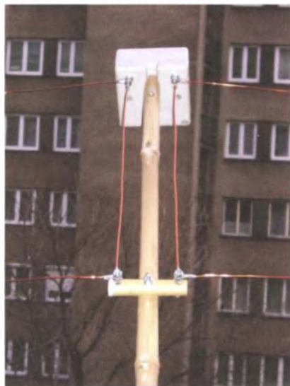
Obr. 6. Symetrické spojovací vedení upevněné na podpůrném ráhnu s ochranným krytem anténních svorek
