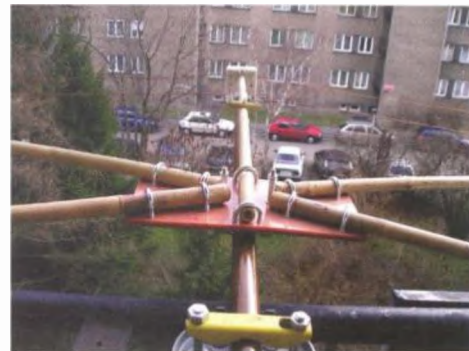
Obr. 8. Pohled na sestavenou anténu Moxon, upevněnou na zábradlí panelákové lodžie, před vysunutím do definitivní polohy
