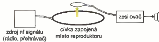
Obr. 8. Přenos nf signálu indukční vazbou
