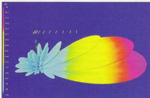
Obr. 15. Trojrozměrný vyzařovací diagram dlouhé devítiprvkové antény pro 50,150 MHz
