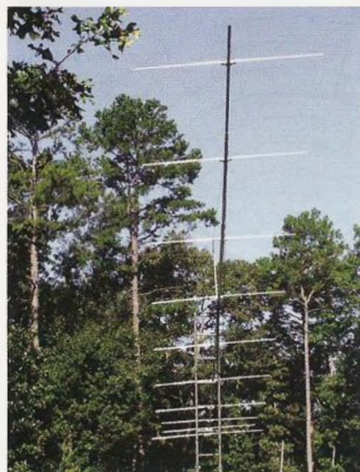
Obr. 19. Dlouhá devítiprvková anténa v provedení WA4NJP (vlevo)
