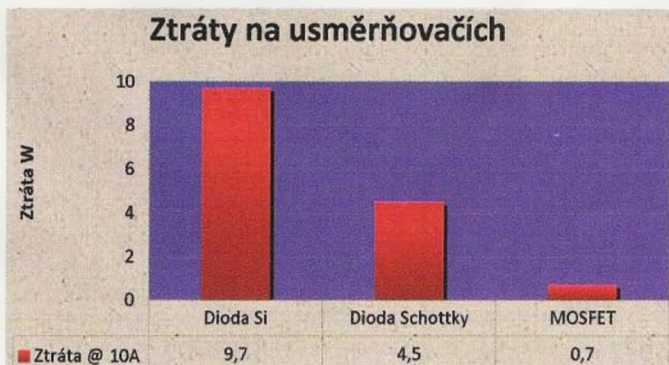
Obr. 1. Graf pro porovnání velikosti ztrát na jednotlivých usměrňovačích prvcích
