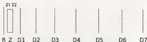
Obr. 12. Konstrukční náčrtek dlouhé devítiprvkové antény pro 50,150 MHz
