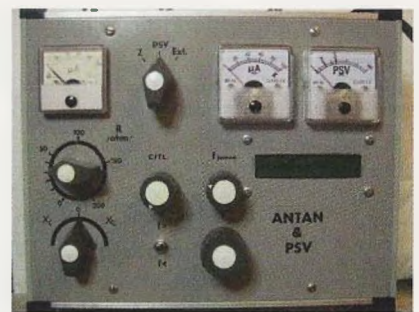
Obr. 3. Přední panel mého anténního analyzátoru, vyrobeného podle námětu Luca Pistoriuse, F6BQU
