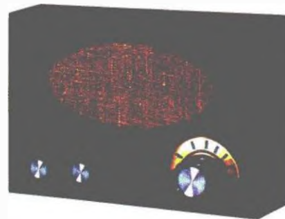
Obr. 3. Stavebnice krátkovlnného radio-přijímače, jenž principem příjmu odpovídá elektronkovému audionu z doby počátků rozhlasové techniky
