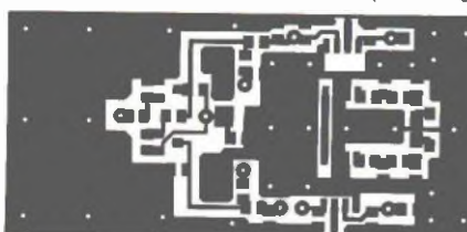
Obr. 15. Deska s plošnými spoji atenuátoru 2 (rozměry 55 x 25 mm)
