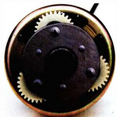
Obr. 4. Fotografie běžného motoru s planetovou převodovkou
