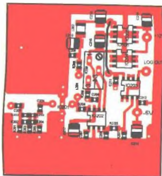
Obr. 12. Deska s plošnými spoji logaritmického zesilovače (rozměry 40 x 45 mm)
