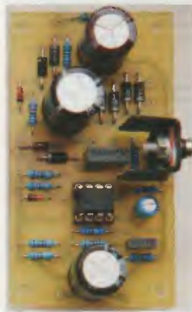
Obr. 8. Deska jednočinného zvyšujícího měniče DC/DC osazená součástkami
