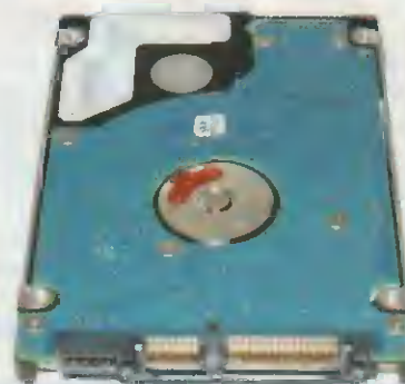
Hybridní disk společnosti Seagate Momentus XT Hybrid Drive má na desce s elektronikou polovodičovou paměť 4 GB
