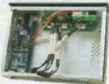
Vlevo skříňka počítače ARTiGO s deskou konektoru a deskou napájecí části, vpravo již „plná“ s připojenou základní deskou, pevným diskem (zespodu) a ventilátorem
