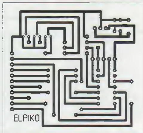
Obr. 4 a 5. Deska s mikrokontrolérem (60 x 65 mm) a rozmístění součástek na desce
