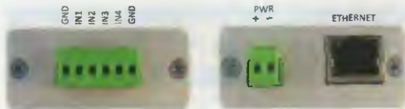
Obr. 4. Svorkovnice vstupů a připojení k napájení a síti
