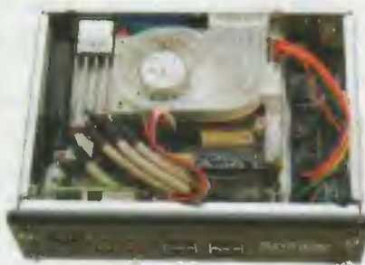
Vlevo skříňka počítače ARTiGO s deskou konektoru a deskou napájecí části, vpravo již „plná“ s připojenou základní deskou, pevným diskem (zespodu) a ventilátorem
