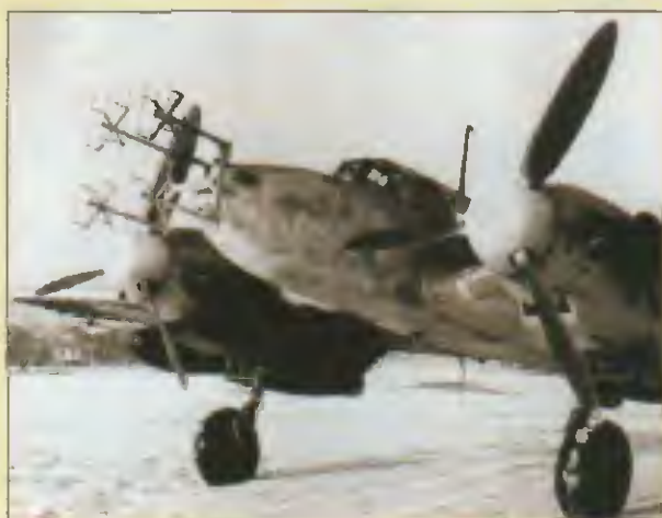
Obr. 1a. Palubní radar FUG 202 Lichtenstein B/C, pod kódovým názvem EMIL – EMIL. Byl vyvíjen na konci 30. let firmou Telefunken. Jeho testy ve vojenských podmínkách přišly na řadu v srpnu 1941. Zkoušel se na palubě letounu Do 215B-5 Obit. Becker, který s jeho pomocí sestřelil 6 nepřátelských bombardérů. Do sériové výroby se radar dostal na jaře 1942. Je to první německý radar použitelný v bojových podmínkách
