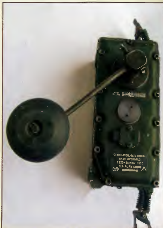
Obr. 3. Ruční generátor pro provoz radiostanice, příp. k dobíjení akumulátorů
