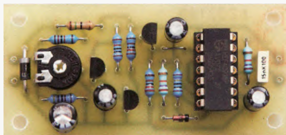
Obr. 3. Deska se součástkami akustického signalizátoru nízkého napětí baterie
