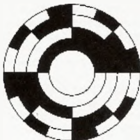
Obr. 9. Stínítko pro 4bitový absolutní snímač polohy
