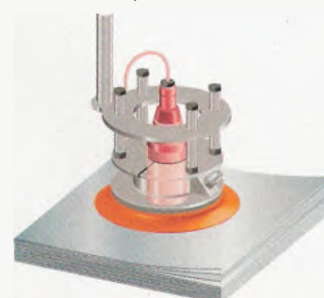
Obr. 2. Jednostranná indikace dvou plechů
