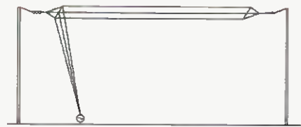
Obr. 3a. Příklad dlouhovlnné antény s kapacitní zátěží
