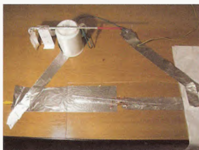
Obr. 7. Indikátor 1 paralelně k indikátoru 2 s předřadným kondenzátorem C_p
