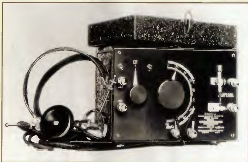
Obr. 2. Jedna z prvních krystalek vyrobená firmou RCA (vlevo nahoře)
