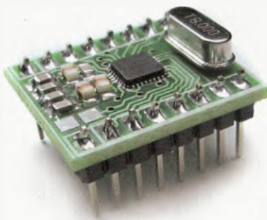
Obr. 11. Hotový bezdrátový modul a označení jeho vývodů
