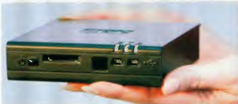
Počítač fit-PC2 se slušným vybavením se vejde do 313 cm 3
