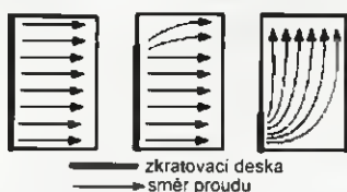
Obr. 1 c. Rozložení proudu u zkratovací desky
