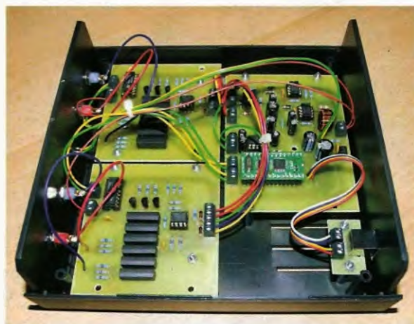
Obr. 15. Hotová sonda se dvěma moduly měření napětí
