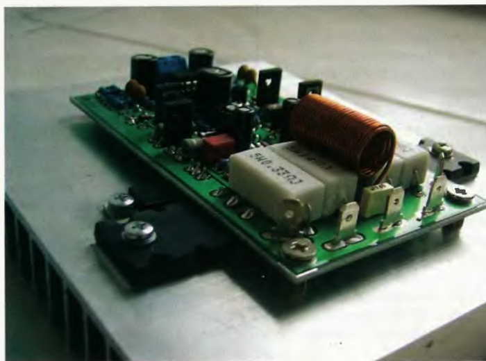
Obr. 10. Fotografie prototypu audiozesilovače s chladičem
