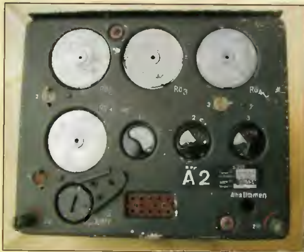
Obr. 10. Vysílač S 203 „Kehl“ byl řízen krystalem a o dostatečný výkon se postaraly čtyři elektronky LS50
