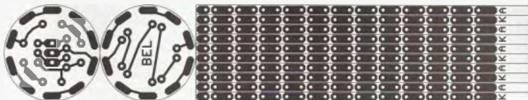
Obr. 2. Obrazec plošných spojů (139,7 x 25,4 mm) LED žárovky
