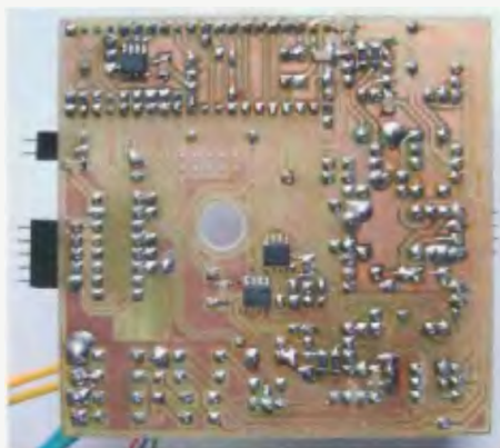
Obr. 9. Osazení součástkami SMD
