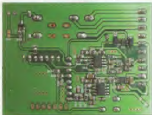
Obr. 15 b. Rozmístění součástek vysílačeho modulu - strana Bottom
