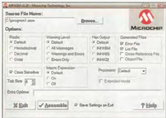
Obr. 16. Program MPASM, který slouží pro vygenerování souboru .hex s programem pro mikrokontrolér ze souboru .asm se zdrojovým kódem v jazyce assembleru. Program je součástí distribuce vývojového prostředí MPLAB, lze jej však použít i samostatně.
