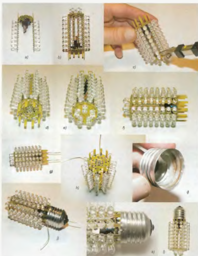
Obr. 4. Postup montáže LED žárovky
