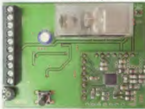
Obr. 15 c. Rozmístění součástek vysílačeho modulu - strana Top
