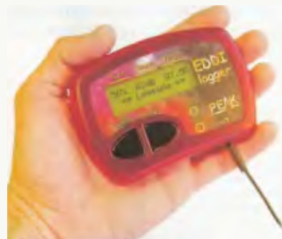
Peak EDDI měří teplotu, hluk a osvětlení
