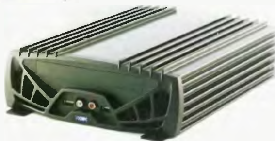
Pohled zezadu a zepředu na skříňku VoomPC-2 pro počítač do auta se základní deskou (motherboard) typu mini-ITX
