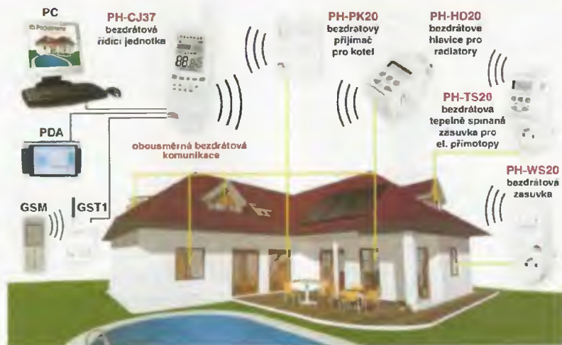
Systém bezdrátového řízení vytápění a ovládání elektrických spotřebičů PocketHome
