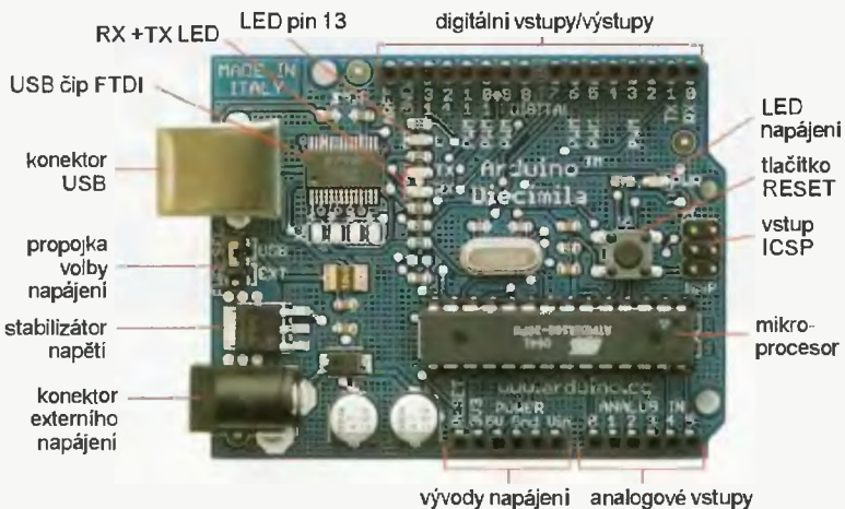
Deska Arduino Diecimila v měřítku 1:1 a její hlavní součástky
