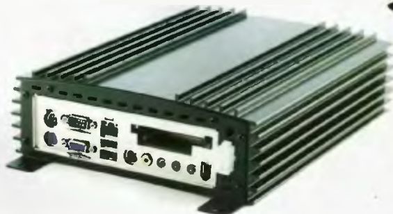
Pohled zezadu a zepředu na skříňku VoomPC-2 pro počítač do auta se základní deskou (motherboard) typu mini-ITX
