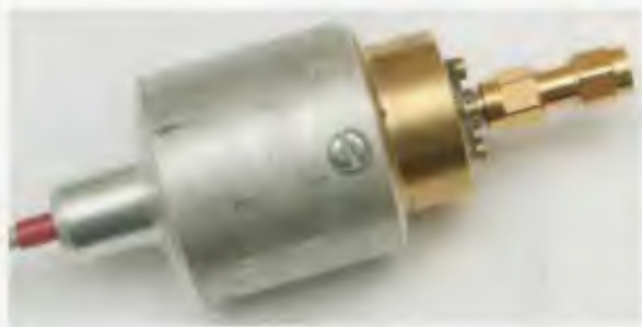
Obr. 9. Náčrt mechanického provedení sondy s diodou 36NQ52 a fotografie
