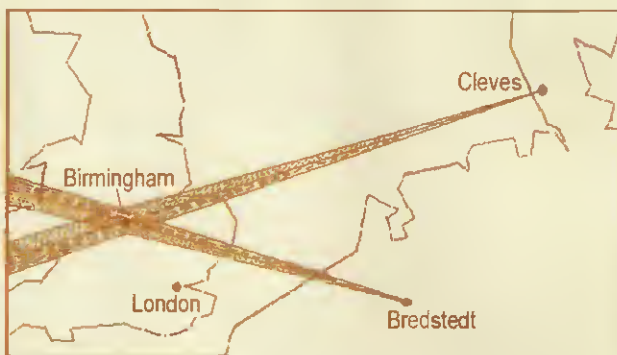
Obr. 3. Schéma směřování Knickebeinu při náletu na Birmingham
