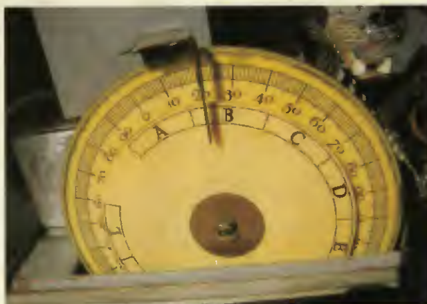
Obr. 2. Detail odkryté stupnice přijímače H2L/7 (vpravo)
