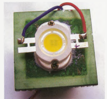
Obr. 5 a 6. Osazená deska a LED na chladiči
