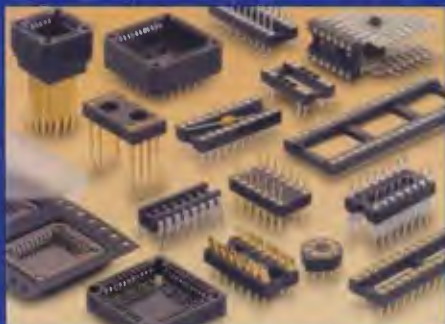
Patice v provedení DIL, PGA a PLCC ozlacené a pocínované povrchy pro klasičku a SMD letovací techniku, a různá provedení pouzder TO
