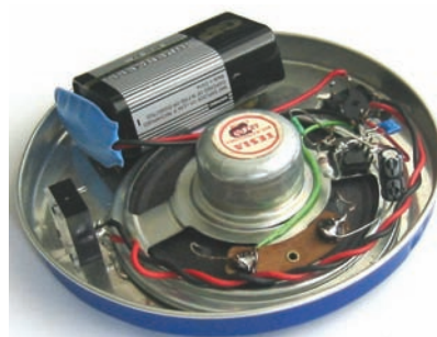
Obr. 3. Bzučák NIVEA - pohled dovnitř
