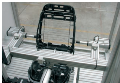
Aplikace profilového systému a pohonných jednotek na testovacím zařízení automobilových sedadel
