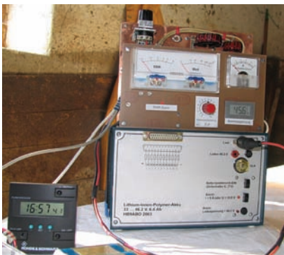
Obr. 7. Koncový stupeň 200 W třídy E HB9ABO v akci při NMD v kravínu. PA je napájen baterií LiPo 42 V s kapacitou 6,4 Ah
