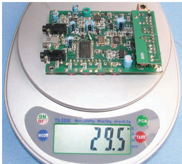
Obr. 2. Kompletní transceiver, vážící pouhých 30 g! Appalachian Trail Sprint 3 od KD1JV (vpravo)
