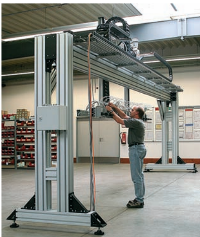
Portálová jednotka sestavená z profilového systému
