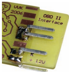
Obr. 4. Detail zhotoveného nožového konektora OBD II (5 pinov)
