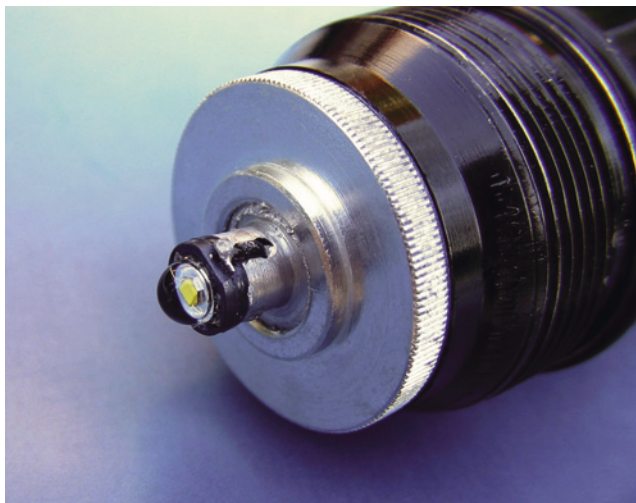
Fotografie adaptéru pro výkonovou LED ve svítilně ESP
