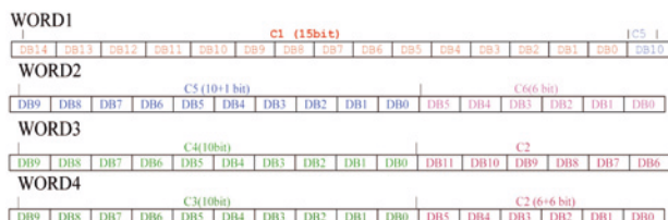
Obr. 2. Převod kalibračních dat na kalibrační koeficienty
