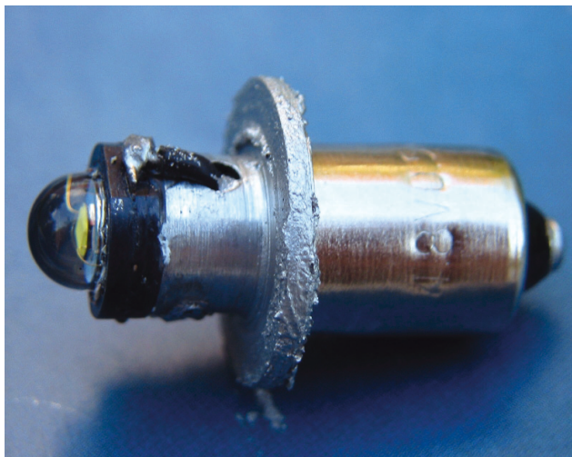
Fotografie adaptéru pro výkonovou LED ve svítilně ESP
