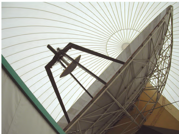
Obr. 2. Pod kopulí je teleskop s Cassegrainovým uspořádáním
