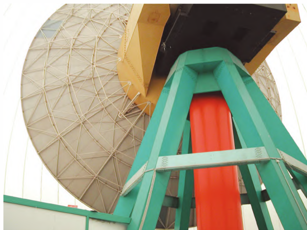
Obr. 2. Pod kopulí je teleskop s Cassegrainovým uspořádáním
