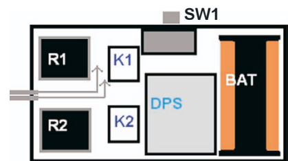
Obr. 4. Uspořádání součástek a dílů ve skříňce zesilovače. R1 a R2 jsou tandemové potenciometry, K1 a K2 jsou výstupní zásuvky JACK 3,5 mm, stereo pro sluchátka, DPS je deska zesilovače a BAT je držák se dvěma napájecími tužkovými články. Nad DPS je posuvný spínač napájení SW1
