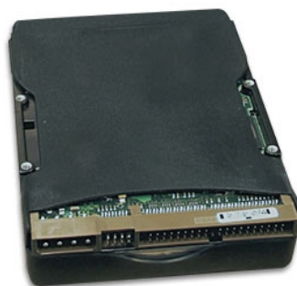
Seagate U6 - pružná gumová košilka je průvodním znakem série „U“ (U5 i U6)
