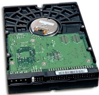
Caviar WD400BB - elektronika také není příliš chráněná
