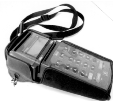
Obr. 3. TESLA je také distributorem tzv. platebního terminálu P2000, umožňujícího zasílat informace z magnetických i čipových karet na dálku prostřednictvím sítě GSM na 900 i 1800 MHz pro nejrůznější aplikace, francouzského výrobce GML
