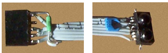
Obr. 2. Všechny součástky jsou připájeny k propojovacímu kabelu
