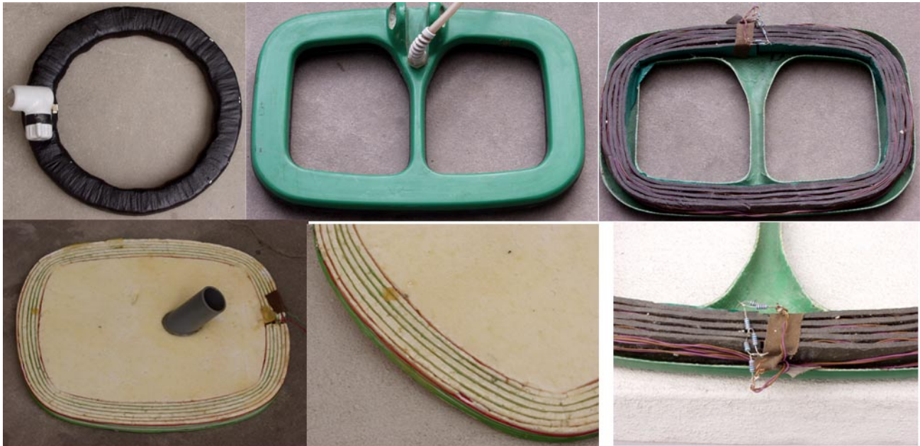
Obr. 13. Různá provedení cívký (cívka obdélníková s příčkou má proklad z „pěnovky“; obdélníková cívka má proklad s polystyrenu)
