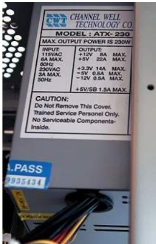
Údaje o napětích a zatížitelnosti napájecího zdroje v počítači jsou uvedeny na jeho štítku
