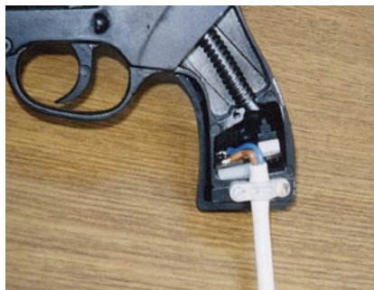
Obr. 5. Umístění spínače v rukojeti pistole
