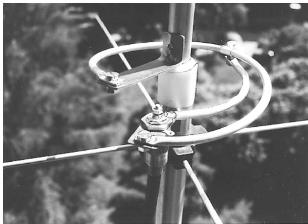
Obr. 2. Pohled na upravené napájení
