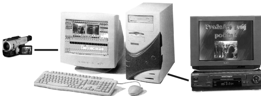
Pracoviště pro zpracování videozáznamu na osobním počítači - kamera, osobní počítač, videorekordér, televizní přijímač
